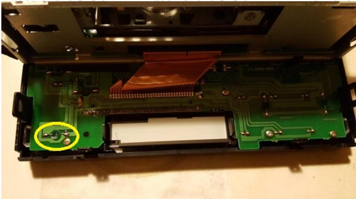
Avec le fer à souder et le tout petit tournevis plat, dessouder les fils des ampoules, puis sortir l'ampoule, le globe reste en place. On retourne l'ampoule en pinçant les fils dans ses doigts:
