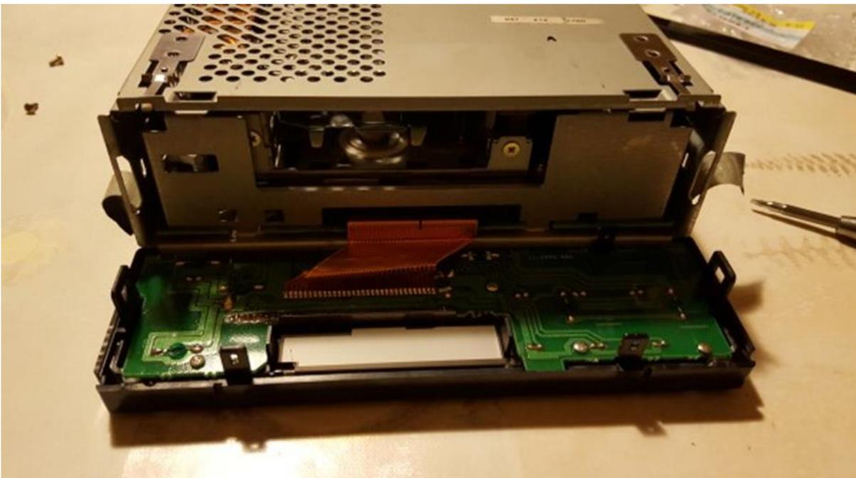
On aperçoit bien les petites ampoules logées dans une sortie de globe vert souple (c'est ce qui donne la couleur verte à l'affichage), j'ai entouré l'une d'elle en jaune par exemple. A noter qu'une ampoule est caché sous le large faisceau plat marrons et pour la changer, il faut retourner l'autoradio.
